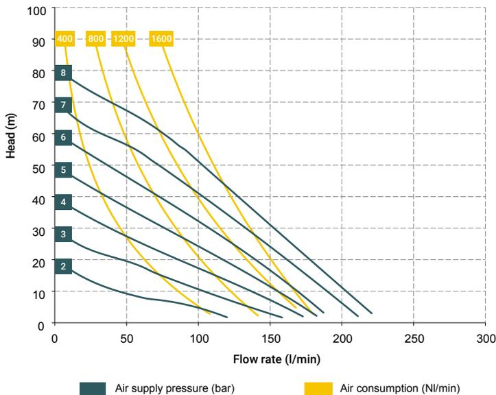
\*Die Kurven und Leistungen beziehen sich auf Pumpen mit Tauchansaugung und freiem Druckanschluss, mit Wasser bei einer Temperatur von 20 °C und variieren je nach Materialzusammensetzung.
